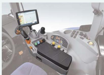
ニューホランド純正の自動操舵「インテリステア」はトラクターのシステムに完全に統合されています。余分な配線が一切見えないスタイリッシュな内装はトラクター統合型システムだからこそ実現ができました。
