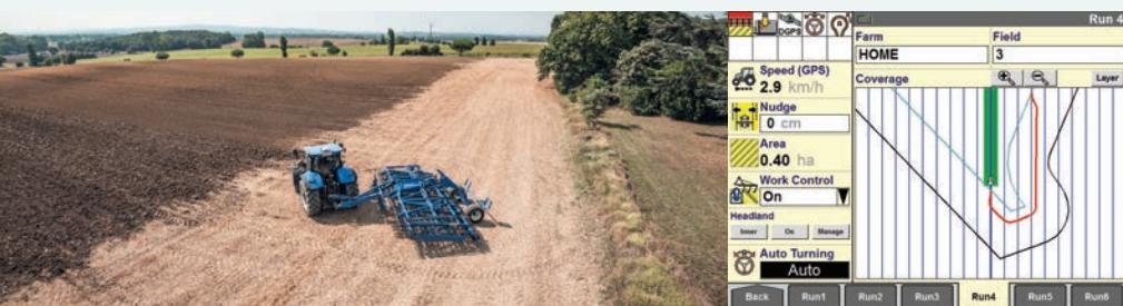
枕地の自動旋回機能「インテリターン」は、ハンズフリーで次の畠に一発で入ることが可能です。入る畠は隣だけでなく、1本2本飛ばしなど、自由に設定できますので、切り返しが不要となり作業効率を飛躍的に高めます。
