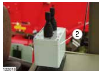
②バンカー操作用補助コントローラー
