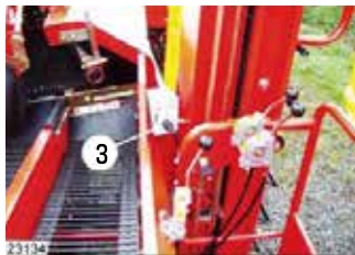
③小芋排出エレベーターコントローラー
