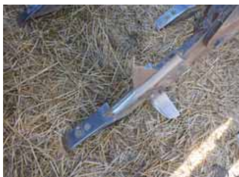
標準装備の三角ナイフと左右のウイングで硬盤層を破壊します。
