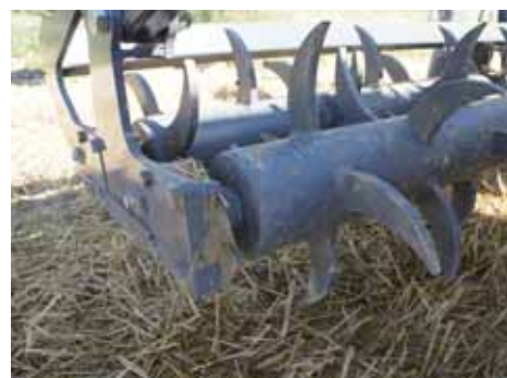
2本のナイフローラーで土塊を砕き、残さ物と混和します。
