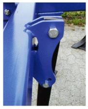
衝撃吸収方式はシェアボ ルト式。 石の多い圃場でも作業機
