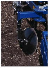
アウターディスク (外側) により土の横移動を抑 え、作業幅内に土を留め ます。
