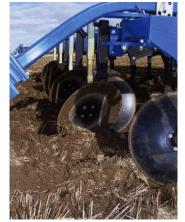
標準装備の直径 46cm の ディスクが耕起後の土壌 を攪拌し残渣物との混合 を促進させ、より早い腐 植を促します。
