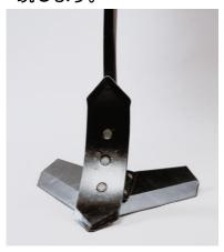
幅 48cm のウイング付タイン が確実に掘り起こし、表面の 残渣物を鋤き込みます。 作業深度は深さ 4~20cm。 ナイフ部分はリバーシブルで 経済的です。
