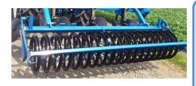
ダルボ社独自の T リングローラーにより砕土、適度な整地と 鎮圧を行います。
