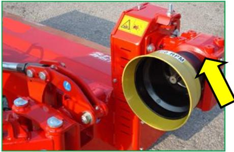
水平方向により大きくオフセットできるようにギヤボックスが外側に配置されています。
